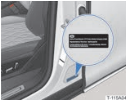
Das Herstellerdatenschild befindet sich am unteren Teil der linken B-Säule.
