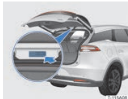
Schilder mit Modell und Nummer des Heckantriebsmotors sind auf der Innenseite der Heckklappe aufgeklebt.
