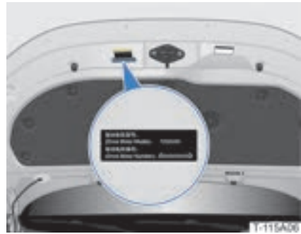
Schilder mit Modell und Nummer des Frontantriebsmotors sind auf der Innenseite der Motorhaube aufgeklebt.
