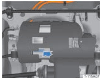
Modell und Nummer des Frontantriebsmotors sind in das Frontantriebsmotorgehäuse eingraviert.
