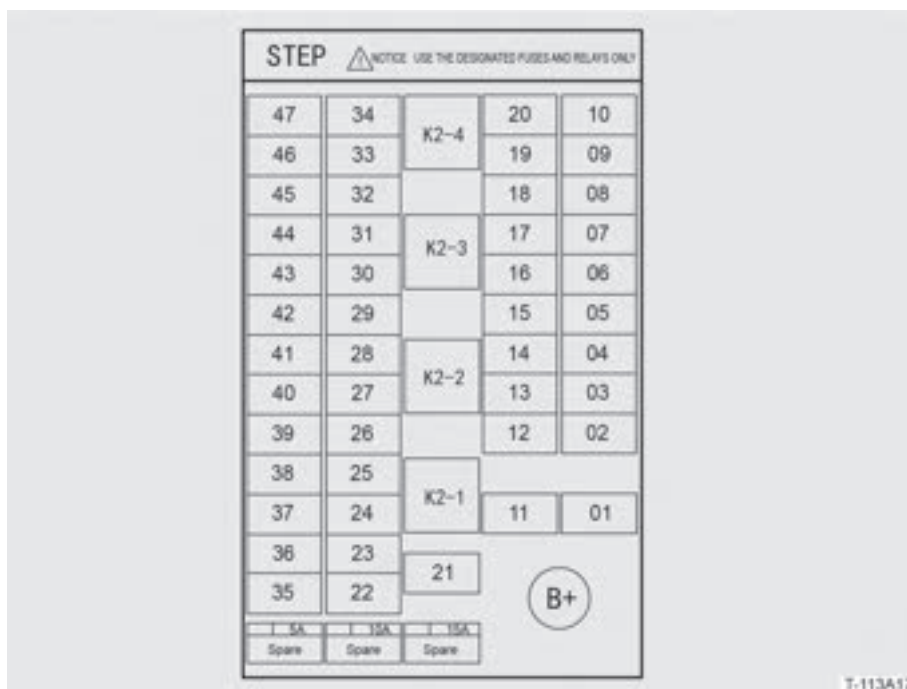
Verteilung der Armatumentafel-Sicherungskästen
