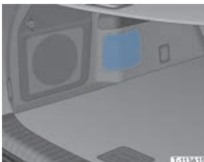
Sicherungskasten im hinteren Abteil
