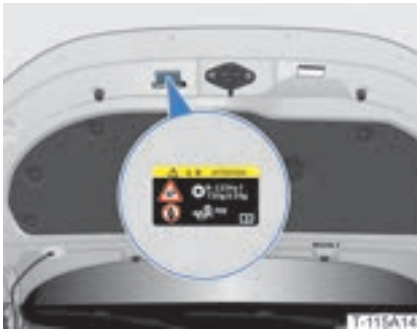
Warnaufkleber für Kältemittelauffüllung und Kühllüfter
