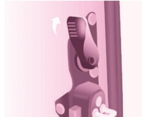
Ziehen Sie den Hebel, um die rechte Tür zu öffnen. Beim Schließen beginnen Sie mit der rechten Tür und schließen dann die linke Tür.
