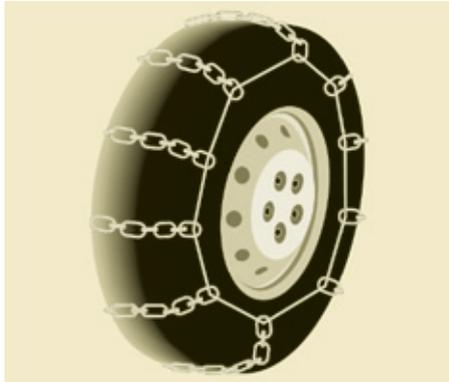
**i** Die Schneeketten dürfen nur auf die Vorderräder montiert werden. Sie dürfen nicht auf Noträdern montiert werden.
