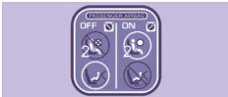
**+** Beim Einbau eines Kindersitzes entgegen der Fahrtrichtung muss der Beifahrer-Front-Airbag unbedingt deaktiviert werden.
