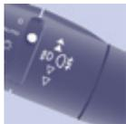
Zum Ausschalten der Nebelschlussleuchten und der Nebelscheinwerfer Ring zweimal nach hinten drehen.
