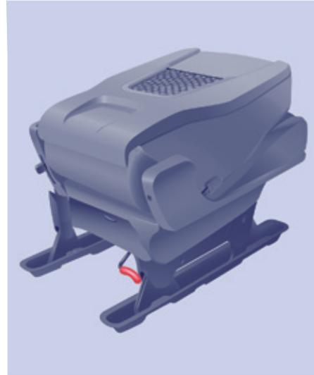
**Typ 2:** Einzelsitz, der gekippt werden kann und dessen Rückenlehne nach vorne flach umgelegt werden kann, um den Zugang zum hinteren Bereich zu erleichtern.
