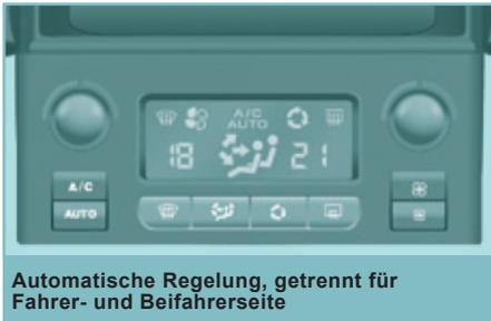
Automatische Regelung, getrennt für Fahrer- und Beifahrerseite
