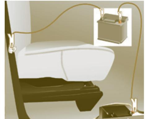
Batterie frühestens zwei Minuten nach dem Ausschalten der Zündung abklemmen. Kabelschuhe nicht bei laufendem Motor abklemmen.
