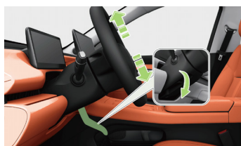
Neigungsverstellung des Lenkrads
