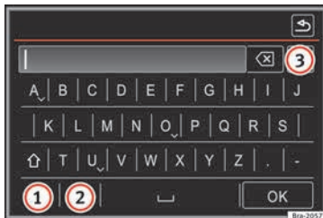
Abb. 4 Prinzipdarstellung: Eingabemaske mit Bildschirmtastatur.
