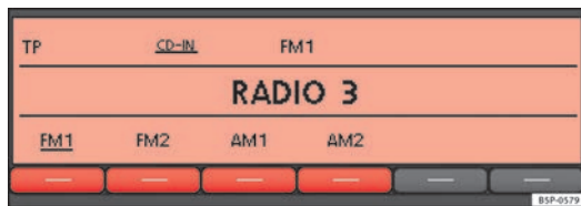
Abb. 3 Hauptmenü RADIO: Frequenzbereiche mit Speicherebenen werden angezeigt.
