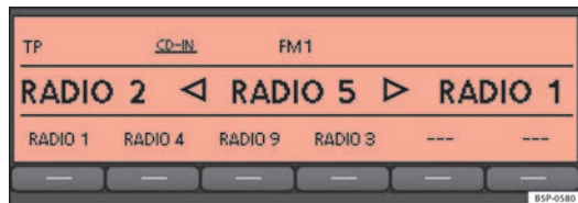
Abb. 4 Senderwechsel über die Wipptaste [◀SEEK / ... ▶].
