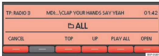
Abb. 22 MEDIA-IN-Betrieb: Ordnerstruktur einer MDI-Quelle wird durchsucht.
