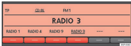
Abb. 8 Auf Stationstasten der Speicherebene FM1 gespeicherte Sender.
