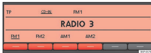
Abb. 7 Frequenzbereich und Speicherebene auswählen.
