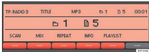
Abb. 15 Anzeige des Speicherorts beim Titelwechsel im MP3-Betrieb.
