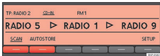
Abb. 6 Radio-Zusatzfunktionen und laufende automatische Sendersuche (SCAN).
