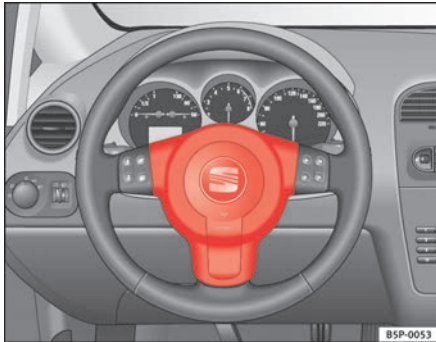
Abb. 18 Einbauort Fahrerairbag: im Lenkrad
