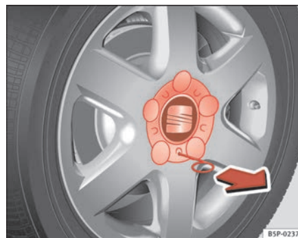
Abb. 176 Radwechsel: Radzierkappe abziehen
