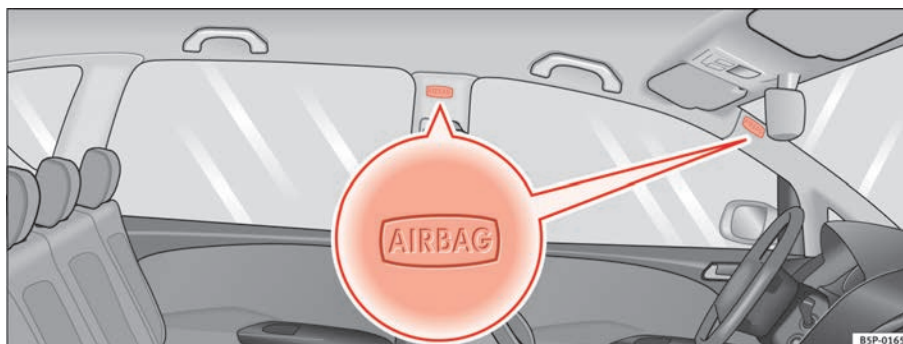
Abb. 24 Einbauort der Kopfairbags auf der linken Fahrzeugseite
