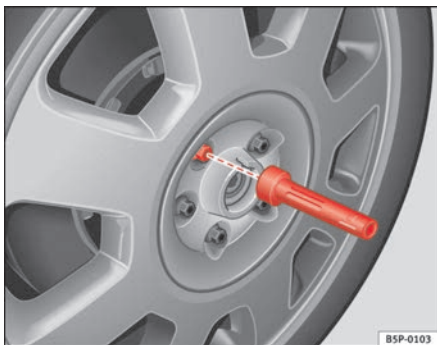
Abb. 181 Radwechsel: Innensechskant zum Drehen der Schrauben
