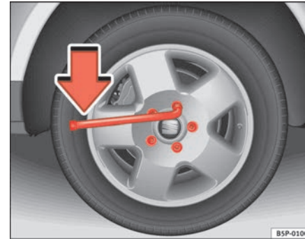
Abb. 177 Radwechsel: Radschrauben lockern
