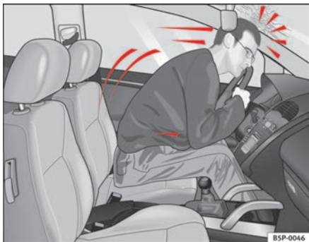
Abb. 9 Der nicht angegurte Fahrer fliegt nach vorne
