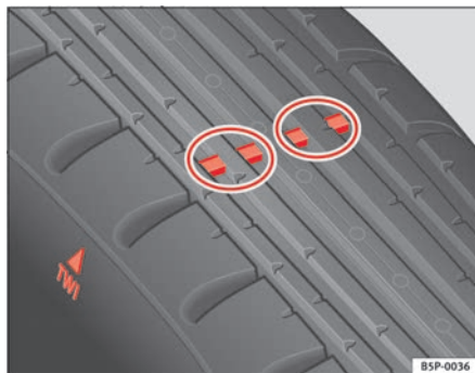
Abb. 173 Prinzipdarstellung Reifenprofil: Verschleißanzeiger
