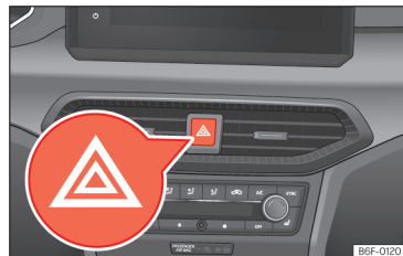
Abb. 41 Schalttafel: Schalter für die Warnblinkanlage
