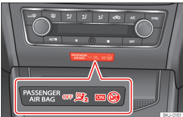
Abb. 28 Schalttafel-Mittelteil: Kontrollleuchte für abgeschalteten Beifahrerairbag.
