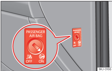
Abb. 27 Schlüsselschalter zum Ein- und Abschalten des Beifahrerairbags.
