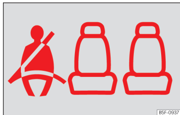
Abb. 18 Kombi-Instrument: Gurtstatusanzeige für die hinteren Sitzplätze.
