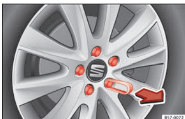
Abb. 70 Rad: Radschrauben mit Deckel.
