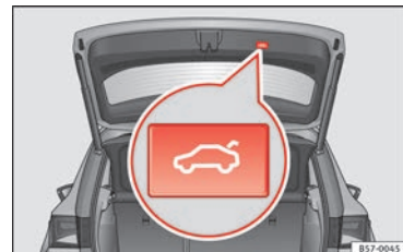
Abb. 6 Heckklappe: Taste zum Schließen der Heckklappe.
