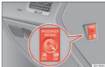
Abb. 22 Schalter für Beifahrer-Frontairbag.
