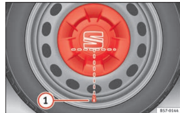
Abb. 69 Korrekte Anbringung der Radvollblende für Stahlfelgen.
