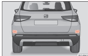
Abb. 195 Bereich hinter dem Fahrzeug: Bereiche der Radarsensoren.
