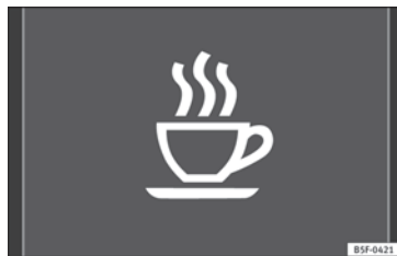
Abb. 201 Im Display des Kombiinstrumentes: Symbol der Müdigkeitserkennung.
