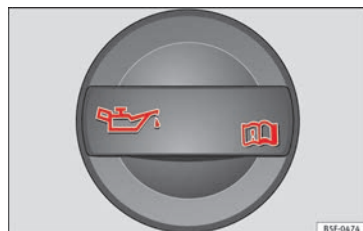
Abb. 60 Deckel der Motoröl-Einfüllöffnung im Motorraum
