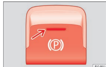
Abb. 167 Im unteren Bereich der Mittelkonsole: Taste für die elektronische Parkbremse.
