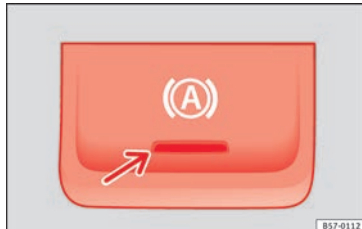
Abb. 172 Im unteren Bereich der Mittelkonsole: Funktionstaste Auto-Hold.
