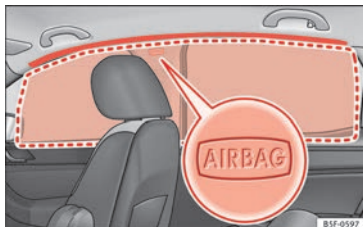
Abb. 27 Einbauort der Kopfairbags
