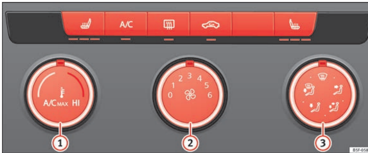
Abb. 56 In der Mittelkonsole: Bedienelemente der manuellen Klimaanlage.
