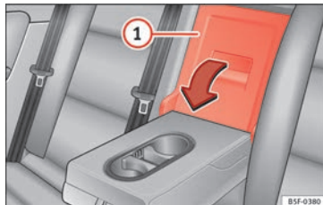
Abb. 154 An der Rückstuhllehne: Öffnung der Durchladeeinrichtung.
