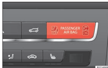
Abb. 51 Kontrolllampchen für Abschaltung des und Beifahrerairbags.
