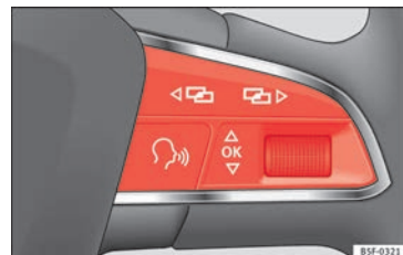
Abb. 43 Rechte Seite Multifunktions-Lenkrad: Steuertasten.
