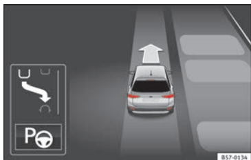
Abb. 204 Im Display des Kombiinstruments: Anzeige des Parklenkassistenten mit eingeschränkter Sicht.
