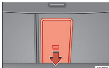
Abb. 155 Im Gepäckraum: Öffnung der Durchladeeinrichtung.
