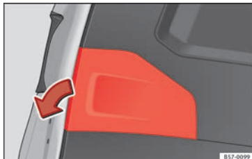
Abb. 112 Gepäckraumklappe geöffnet: Abdeckung entfernen.
