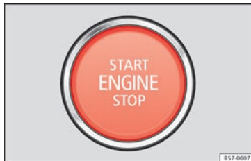
Abb. 166 Im unteren Bereich der Mittelkonsole: Starterknopf.
