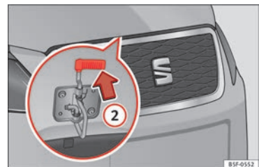
Abb. 10 Hebel unter der Motorraumklappe. »»
