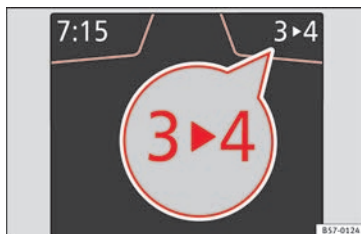
Abb. 45 Kombi-Instrument: Ganganzeige (Handgetriebe).
