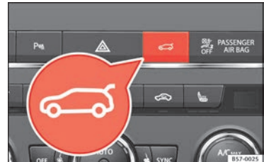
Abb. 132 Mittelkonsole: Taste zum Öffnen und Schließen der Gepäckraumklappe.
