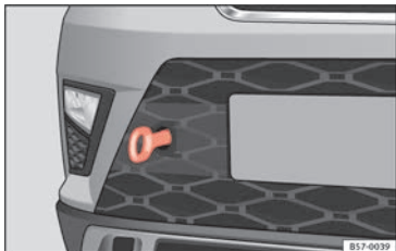
Abb. 75 Vorderer Stoßfänger rechts: Eingeschraubte Abschleppöse
