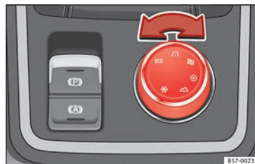
Abb. 199 Mittelkonsole: Drehknopf (Driving Experience button).
