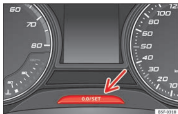
Abb. 118 Kombi-Instrument: Kilometerzähler und Rückstelltaste.
