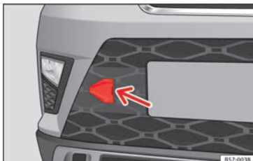
Abb. 97 Auf der rechten Seite des vorderen Stoßfängers: Abdeckung entfernen.
