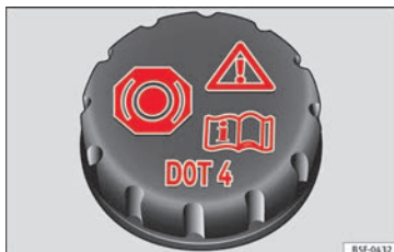
Abb. 62 Motorraum: Deckel des Bremsflüssigkeitsbehälters
