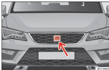
Abb. 179 Im Frontbereich hinter dem SEAT-Emblem: Radarsensor.
