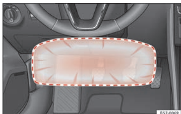
Abb. 24 Auf der Fahrerseite: Wirkungsbereich des Knieairbags.
