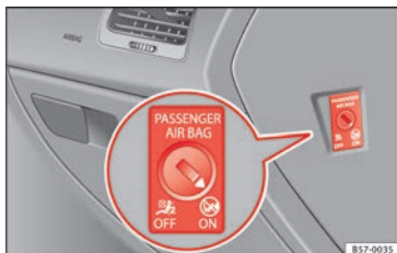
Abb. 94 Schalter für Beifahrer-Frontairbag.
