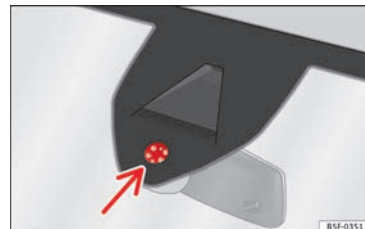
Abb. 141 Sensitive Fläche des Regensensors.
