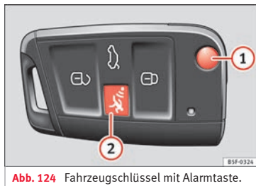
Abb. 124 Fahrzeugschlüssel mit Alarmtaste.
