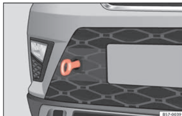
Abb. 98 Auf der rechten Seite des vorderen Stoßfängers: Eingeschraubte Abschleppöse.
