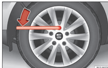
Abb. 74 Rad: Radschrauben lockern.
