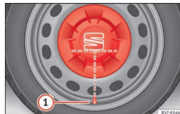
Abb. 71 Korrekte Anbringung der Radvollblende für Stahlfelgen.
