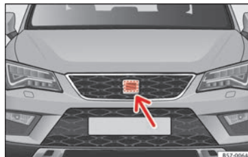
Abb. 196 Im Frontbereich hinter dem SEAT-Emblem: Radarsensor.
