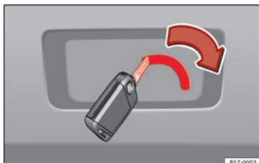
Abb. 8 Ausschnitt Gepäckraum: Notfallentriegelung.
