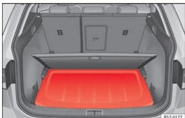
Abb. 162 Im Gepäckraum: Einsetzen der Gepäckraumabdeckung.
