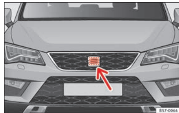
Abb. 191 Im Frontbereich hinter dem SEAT-Emblem: Radarsensor.
