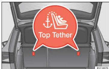
Abb. 33 Lage der Top Tether-Ösen im hinteren Teil des Rücksitzes
