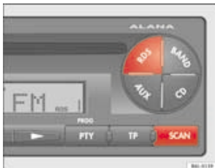
Abb. 18 Autostore im Bereich RDS
