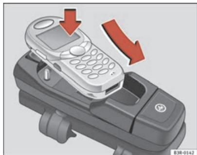
Abb. 14 Mobiltelefon in den Mobiltelefon-Adapter einsetzen
