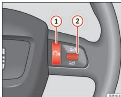
Abb. 16 Multifunktionslenkrad: Sprech taste und rechte Menüwalze
