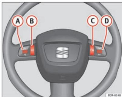
Abb. 20 Bedienelemente am Multifunktionslenkrad
