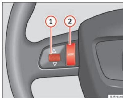
Abb. 18 Multifunktionslenkrad: Linke Menüwalze und MODE-Taste
