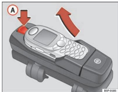
Abb. 15 Mobiltelefon aus dem Mobiltelefon-Adapter herausnehmen
