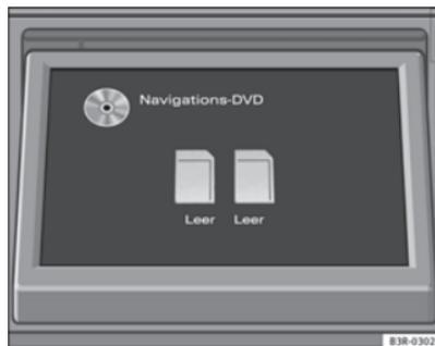
Abb. 29 Aufgeklapptes Display: Lage der Speicherkarte beim Ladevorgang
