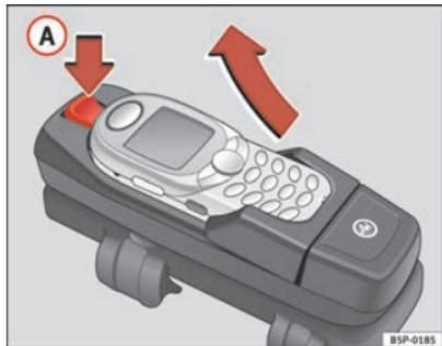
Abb. 87 Mobiltelefon aus dem Mobiltelefon-Adapter herausnehmen
