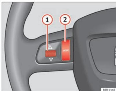
Abb. 110 Multifunktionslenkrad: Linke Menüwalze und MODE-Taste
