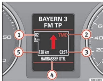
Abb. 118 Display im Kombiinstrument: Beispiel-Darstellung einer Zielführung
