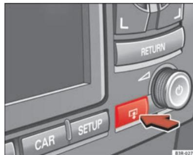
Abb. 3 Navigations-system: Taste zum Auf- und Zuklappen des Displays
