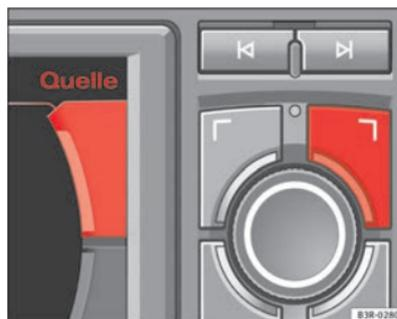
Abb. 6 Navigationssystem: Zuordnung von Steuerungstasten und Tastensymbolen in den Ecken des Displays
