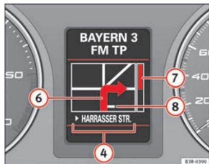
Abb. 119 Display im Kombiinstrument: Beispiel-Darstellung einer Zielführung (Richtungsänderung)
