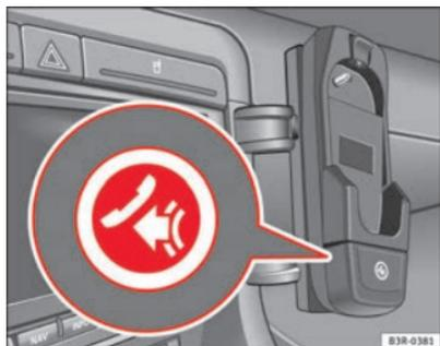
Abb. 107 Beispiel Mobiltelefon-Adapter mit Sprechaste
