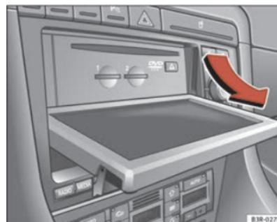
Abb. 4 Aufgeklapptes Display: Zugriff auf das DVD-Laufwerk und die Speicherkartenleser
