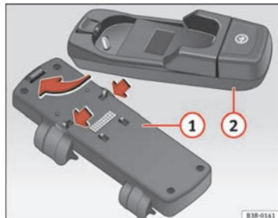
Abb. 85 Mobiltelefon-Adapter einbauen
