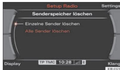
Abb. 52 Setup des Radios (Setup Radio): Senderspeicher löschen
