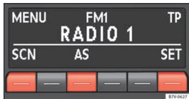
Abb. 6 MENÜ Zusatzfunktionen im Radio-Betrieb: Automatische Sendersuche (SCN), Autostore (AS) und Setup (SET).
