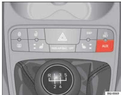
Abb. 9 Anschluss AUX-IN für Ibiza.
