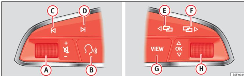
Abb. 6 Bedienelemente am Lenkrad
