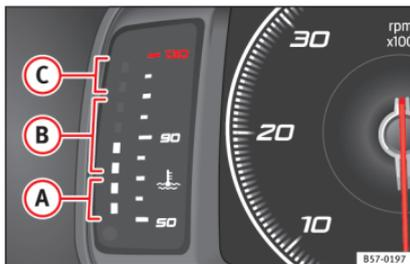
Abb. 4 Motorkühlmitteltemperatur-Anzeige am SEAT Digital Cockpit.
