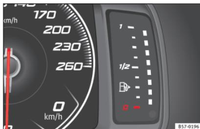
**Abb. 3** Kraftstoffvorratsanzeige am SEAT Digital Cockpit.
