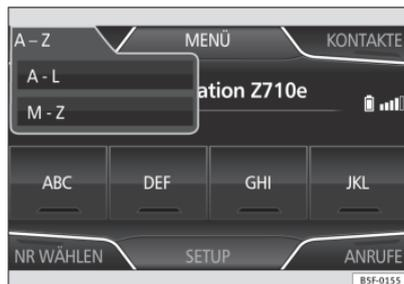
Abb. 31 Standarddarstellung: Tastaturkürzel zum Telefonbuch.
