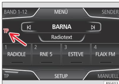
Abb. 11 Standarddarstellung: Hauptmenü RADIO mit TP Anzeige.
