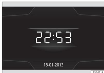
Abb. 38 Standarddarstellung: Display im Standby-Modus.
