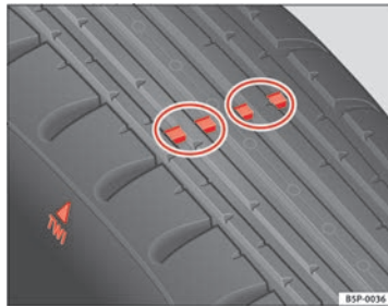
Abb. 124 Reifenprofil mit Verschleißanzeiger
