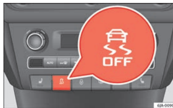
Abb. 104 ESP-System: Schalter für ASR
