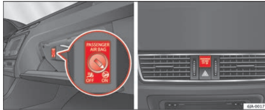
Abb. 24 Schalter für Beifahrer-Frontairbag/Kontrollleuchte für Abschaltung des Beifahrerairbags
