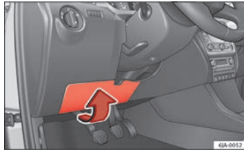
Abb. 140 Sicherungsdeckel: Untere Seite der Instrumententafel
