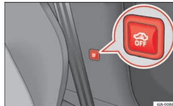
Abb. 50 Taste der Innenraumüberwachung und der Kontrolle des Abschleppschutzes.
