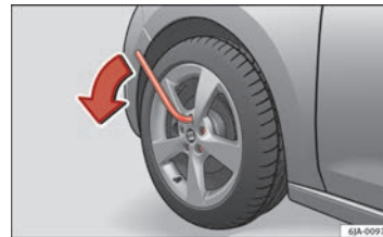
Abb. 131 Radwechsel: Radschrauben lockern ▶
