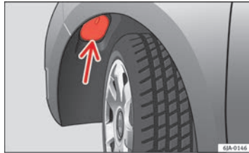
Abb. 149 Glühlampe für Abblendlicht auswechseln: Radkasten
