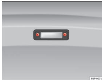
Abb. 165 Ausbau der Kennzeichenleuchte
