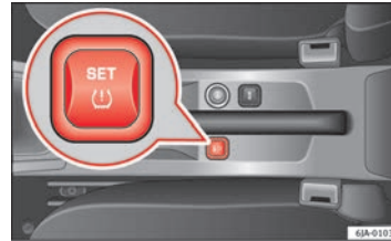
Abb. 128 Taste zum Einstellen des Reifenfülldruck-Kontrollwerts
