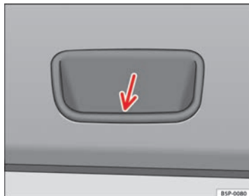
Abb. 52 Ausschnitt aus Innenverkleidung der Heckklappe: Griffmulde zum Zuziehen
