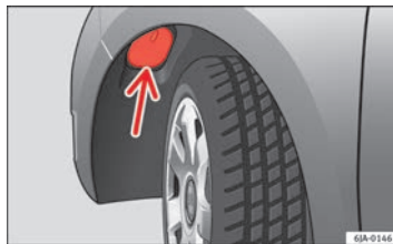
Abb. 155 Lampe für Ablendlicht wechseln: Radkasten
