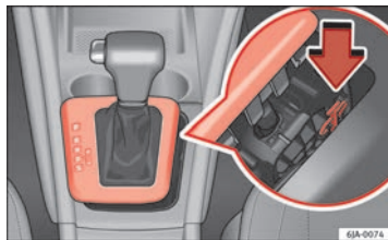
Abb. 107 Notentriegeln der Wählhebelsperre
