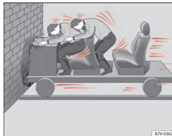
Abb. 7 Prinzipdarstellung: Das Fahrzeug prallt mit nicht angegurtenen Insassen gegen die Mauer
