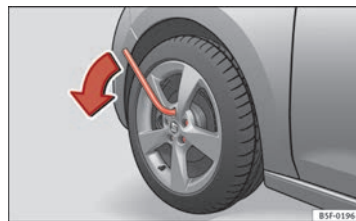
Abb. 138 Radwechsel: Radschrauben lockern ▶
