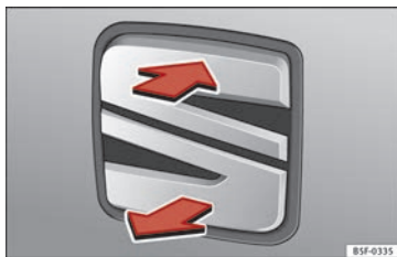
Abb. 42 Heckklappe: Öffnen von außen
