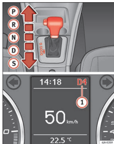
Abb. 92 Wählhebel/ Informations-Display: Wählhebelstellungen
