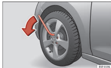
Abb. 124 Radwechsel: Radschrauben lockern »
