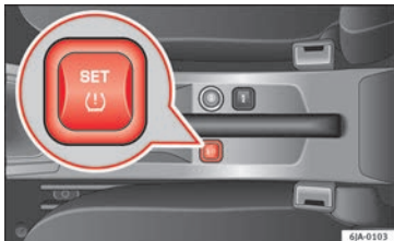
Abb. 120 Taste zum Einstellen des Reifenfülldruck-Kontrollwerts
