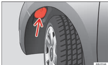
Abb. 146 Lampe für Abblendlicht wechseln: Radkasten
