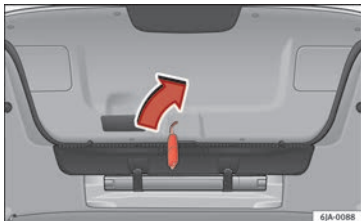
Abb. 134 Notentriegelung der Gepäckraumklappe.
