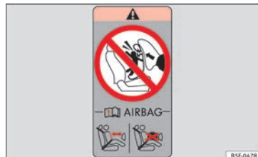
Abb. 20 Im hinteren Rahmen der Beifahrertür: Aufkleber mit Angaben zum Airbag.
