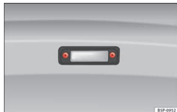
Abb. 162 Ausbau der Kennzeichenleuchte
