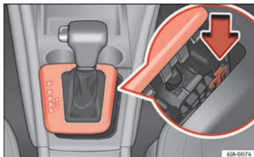
Abb. 135 Notentriegeln der Wählhebelsperre
