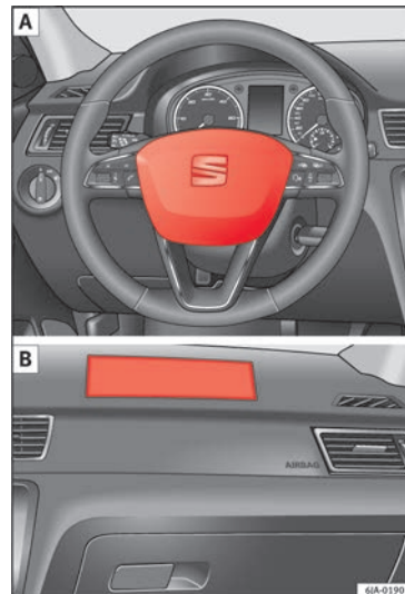
Abb. 12 Fahrerairbag im Lenkrad und Beifahrerairbag in der Instrumententafel
