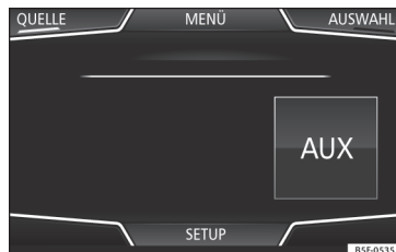
Abb. 29 Media-Betrieb: Externe Audioquelle über AUX-IN-Buchse angeschlossen.
