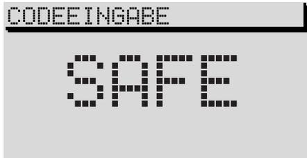
Die Anti-Diebstahl-Codierung Ihres Radio-Navigationssystems verhindert eine Inbetriebnahme des Systems nach einer Spannungsunterbrechung, z. B. während einer Fahrzeugreparatur oder nach Diebstahl.
