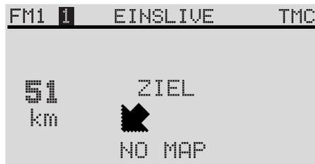
Wenn Sie im Menü **Setup-Navigation** (siehe Seite 14) die Option **FAHRSYMBOLE: AUS** eingestellt haben, erscheinen die optischen Fahrempfehlungen nur auf dem Kombiinstrument. Im Navigationsmodus erscheint im Vordergrunddisplay die Info-Maske und im Hintergrunddisplay die gewählte Audioquelle. Im Audiomodus ist die Darstellung umgekehrt.
