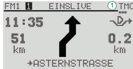
Die Anzahl der empfangenen Verkehrsmeldungen wird unter dem Schriftzug TMC (1) mit Punkten symbolisiert. In der Abbildung sind dies als Beispiel 3 Punkte für 3 Verkehrsmeldungen.
