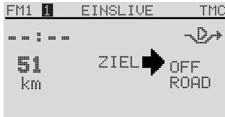
Wenn die Fahrzeugposition keiner Straße der benutzten Navigations-CD zugeordnet werden kann, erfolgt die Zielführung **OFF ROAD**.
