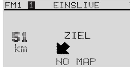
Sie können eine Zielführung auch ohne CD erfolgen lassen. Die Zielführung erfolgt dann ohne Karte. Es werden die Richtung und die Luftlinienentfernung zum Ziel angezeigt. Es erfolgt keine Sprachausgabe.
