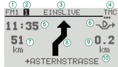
Das Display ist die zentrale Anzeige Ihres Radio-Navigationssystems. Als Beispiel ist hier die Zielführungsmaske abgebildet.
