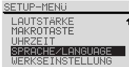
Solche Menüs werden durch Pfeile rechts gekennzeichnet. Die weiteren Menüpunkte werden sichtbar, wenn der Auswahlbalken auf den vorletzten bzw. zweiten Menüpunkt der Liste bewegt wird. Nach einer weiteren Betätigung des Menüknopfes (25) bleibt der Auswahlbalken an der Stelle stehen. Die weiteren Menüpunkte werden sichtbar.
