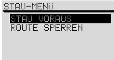
**STAU VORAUS** – Sie können einen Streckenabschnitt sperren, indem Sie den Stauanfang (**VON**) und das Stauende (**BIS**), bezogen auf die Fahrzeugposition, angeben.
