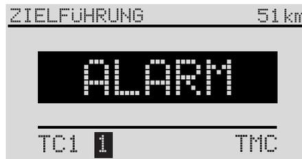
Wenn Ihr Radio-Navigationssystem eine Katastrophenmeldung empfängt, erscheint **ALARM** im Displayvordergrund wie abgebildet bzw. bei aktivierter Zielführung im Displayhintergrund.
