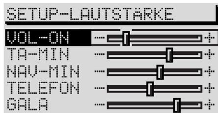
**VOL-ON** - Einstellung der Einschalllautstärke des Systems. Verschieben Sie den Regler auf die gewünschte Lautstärke. Während des Einstellvorgangs wird die momentane Lautstärke mit geändert.
