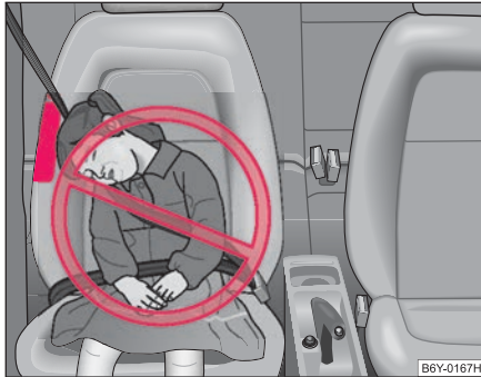
Abb. 107 Das nicht richtig gesicherte Kind in nicht richtiger Sitzposition - gefährdet durch den Seiten-Airbag
