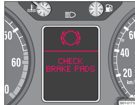
Abb. 15 Informationsdisplay: Bremsbelag verschlissen
