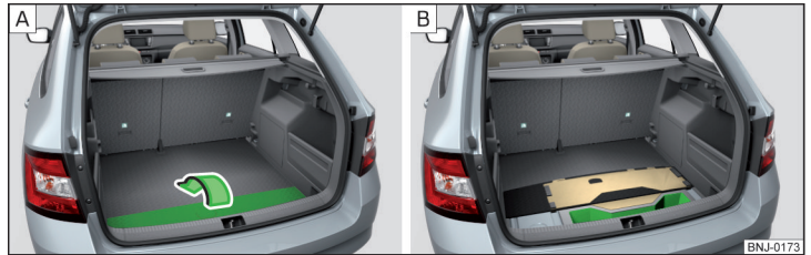
Abb. 103 Boden umklappen / Ablagefach unter dem Boden
