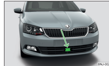
Abb. 144 Einbauort des Radarsensors
