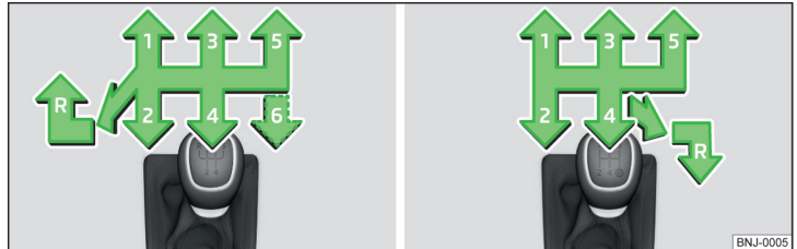
Abb. 126 Schaltschema: Variante 1 (5-Gang- bzw. 6-Gang-Getriebe) / Variante 2 (5-Gang-Getriebe mit dem 1,0 l MPI Motor)
