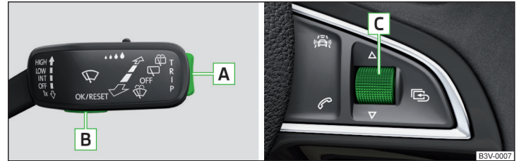
Abb. 28 Tasten/Einstellrad: am Bedienungshebel / am Multifunktionslenkrad
