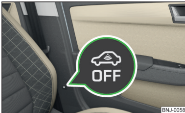
Abb. 42 Taste für Innenraumüberwachung und Abschleppschutz
