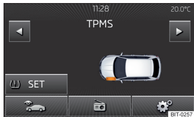
Abb. 148 Taste für Speicherung der Druckwerte / Beispiel der Displayanzeige: das System weist auf eine Reifendruckänderung vorn links hin
