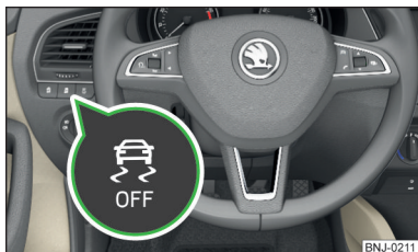
Abb. 132 Systemtaste: ASR deaktivieren/aktivieren
