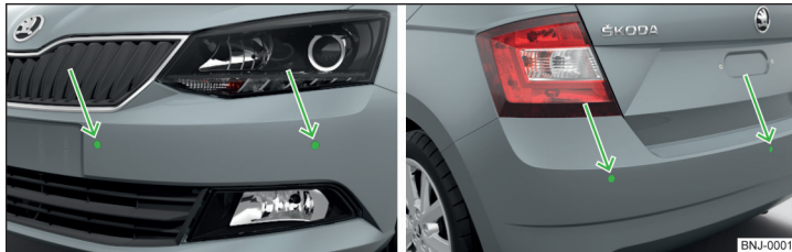
Abb. 133 Einbauort der Sensoren auf der linken Fahrzeugseite: vorn/hinten
