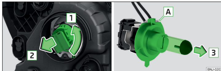
Abb. 211 Glühlampe für Fernlicht wechseln
