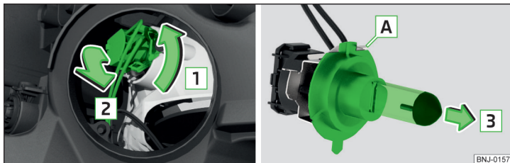
Abb. 210 Glühlampe für Abblendlicht wechseln
