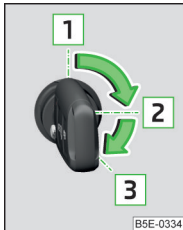
Abb. 120 Positionen des Fahrzeugschlüssels im Zündschloss
