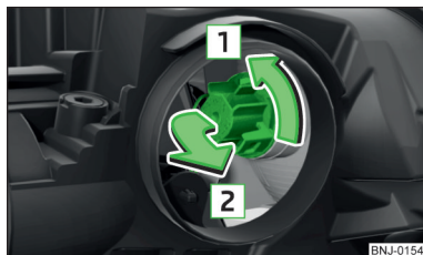
Abb. 207 Glühlampe für Blinklicht vorn wechseln
