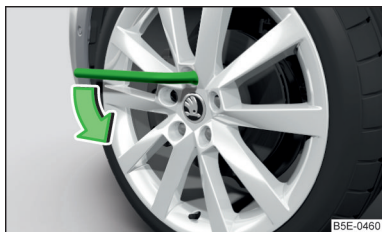
Abb. 183 Radwechsel: Radschrauben lösen
