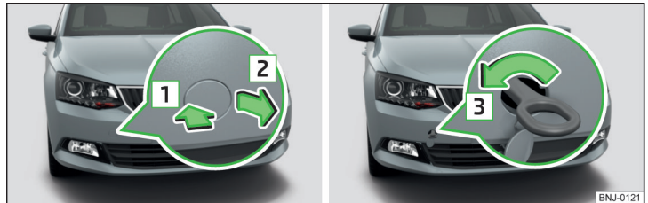
Abb. 190 Ausbau der Abdeckkappe / Einbau der Abschleppöse
