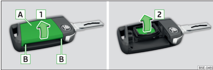
Abb. 192 Funkschlüssel: Abdeckung abbauen / Batterie herausnehmen
