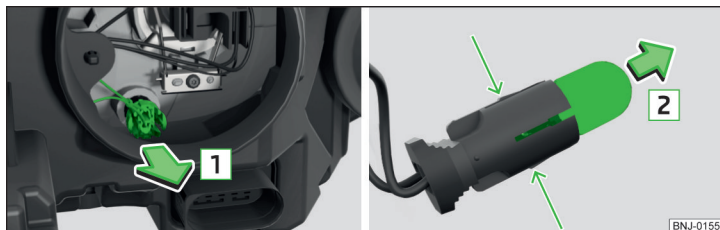
Abb. 208 Glühlampe für Standlicht wechseln
