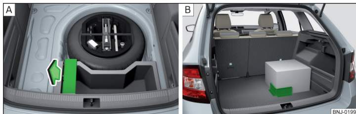
Abb. 104 Cargo-Element herausnehmen / Befestigungsbeispiel der Ladung mittels des Cargo-Elements
