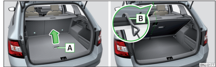
Abb. 109 Variablen Ladeboden hochklappen / Variablen Ladeboden befestigen
