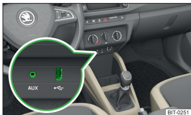
Abb. 89 Einbauorte der AUX- und USB- Eingänge
