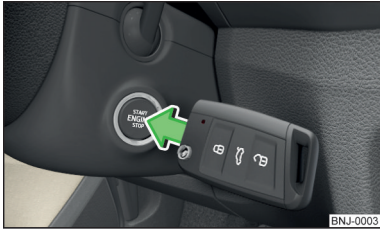
Abb. 122 Motor anlassen - Knopf mit dem Schlüssel drücken
