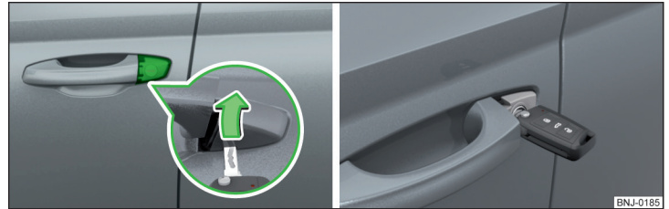
Abb. 193 Griff an der Fahrtür: abgedeckter Schließzylinder / Schließzylinder mit Schlüssel
