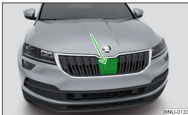
Abb. 248 Verbautort des Radarsensors
