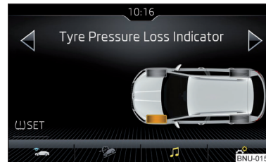
Abb. 287 Taste für Speicherung / Beispiel der Bildschirmanzeige: es wird auf eine Reifendruckänderung vorn links hingewiesen
