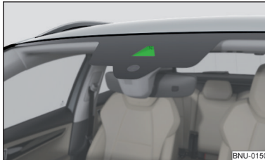
Abb. 282 Sensor für Lane Assist
