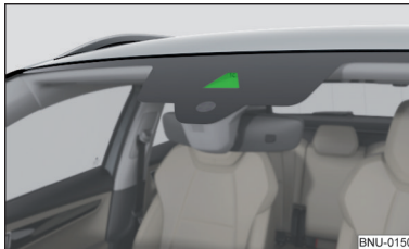
Abb. 285 Sensor für die Verkehrszeichenerkennung
