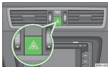
Abb. 22 Schalttafel: Schalter für Warnblinkanlage
