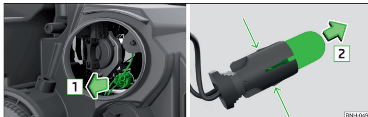
Abb. 156 Glühlampe für Standlicht wechseln
