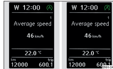
Abb. 100 MAXI DOT-Display: Motor ist automatisch abgeschaltet / automatische Motorabschaltung ist nicht möglich
