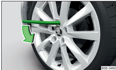
Abb. 133 Radwechsel: Radschrauben lösen
