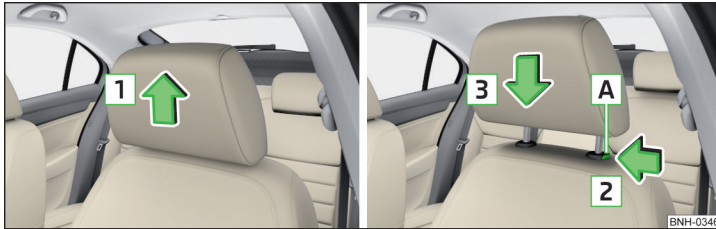
Abb. 52 Kopfstützen: nach oben verschieben / nach unten verschieben
