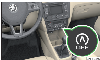
Abb. 101 Taste für das START-STOPP-System
