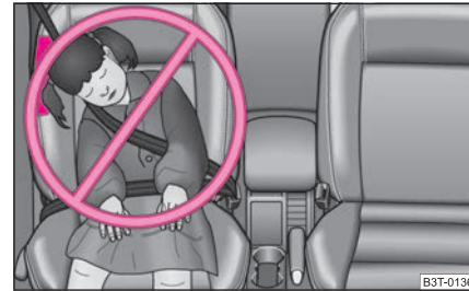
Abb. 166 Das nicht richtig gesicherte Kind in nicht richtiger Sitzposition - gefährdet durch den Seiten-Airbag
