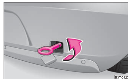
Abb. 211 Hinterer Stoßfänger: Einbau der Abschleppöse
