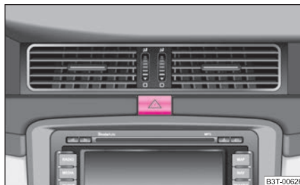
Abb. 46 Schalttafel: Schalter für Warnblinkanlage
