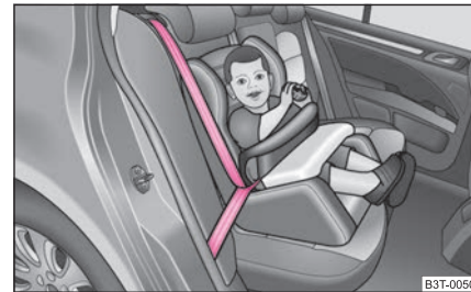
Abb. 169 In Fahrtrichtung eingebauter Kindersitz mit Sicherheitstisch nach Gruppe 1 auf der Rücksitz-bank
