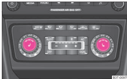
Abb. 71 Schalttafel: Regler für Sitzheizung vorn ▶
