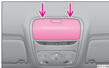
Abb. 39 Ausschnitt des Dachhimmels: Ansatzpunkt des Schraubendrehers ▶
