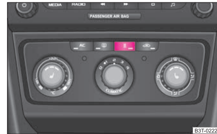
Abb. 118 Taste für direktes Ein-/Ausschalten der Zusatzheizung (Standheizung und -lüftung) auf dem Climatic-Bedienteil
