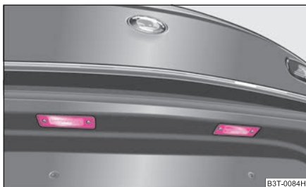
Abb. 226 Hinterer Stoßfänger: Kennzeichenleuchte
