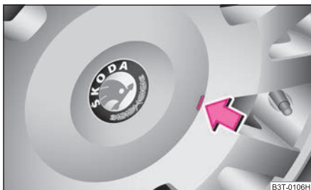
Abb. 203 Abziehen der Radzierkappe bei Leichtmetallrädern
