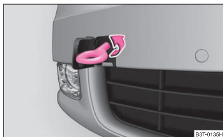
Abb. 209 Vordere Stoßfänger: Einbau der Abschleppöse
