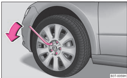
Abb. 204 Radwechsel: Radschrauben lockern
