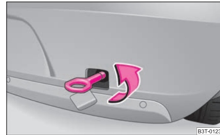
Abb. 211 Hinterer Stoßfänger: Einbau der Abschleppöse
