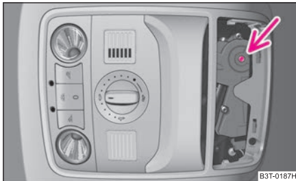
Abb. 40 Ausschnitt des Dachhimmels: Notbetätigung
