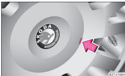
Abb. 203 Abziehen der Radzierkappe bei Leichtmetallrädern
