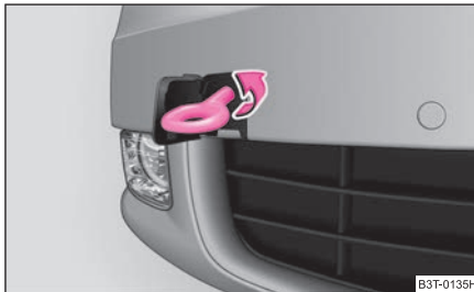
Abb. 209 Vordere Stoßfänger: Einbau der Abschleppöse
