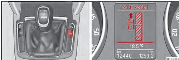
Abb. 122 Anzeige des Parklenkassistenten auf dem Informationsdisplay einschalten / Informationsdisplay: Finden einer geeigneten Parklücke
