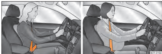
Abb. 141 Gurtbandverlauf des Schulter- und Beckengurts / Gurtbandverlauf bei schwangeren Frauen
