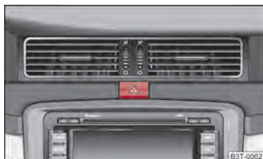
Abb. 39 Schalttafel: Schalter für Warnblinkanlage
