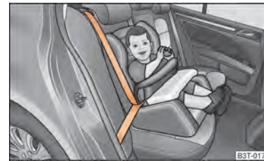
Abb. 156 In Fahrtrichtung eingebauter Kindersitz mit Sicherheitstisch der Gruppe 1 auf der Rücksitzbank
