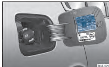
Abb. 179 Geöffnete Tankklappe mit einer Tabelle der Reifengrößen und -fülldruckwerte
