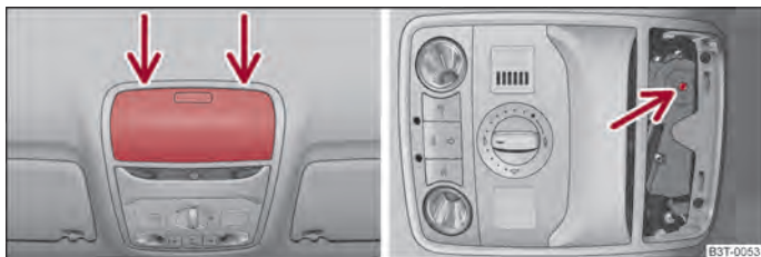
Abb. 30 Ausschnitt des Dachhimmels / Schlüsselansatzpunkt
