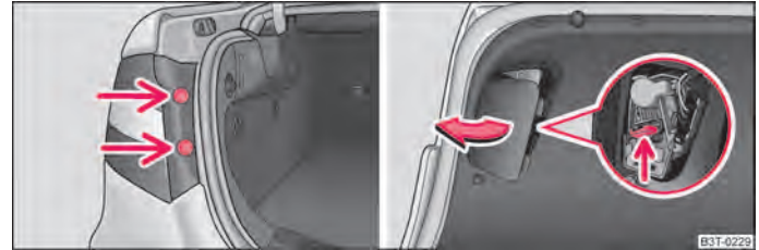
Abb. 207 Ausbau des äußeren Teils der Heckleuchteneinheit / Ausbau des inneren Teils der Heckleuchteneinheit
