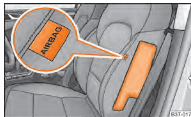
Abb. 148 Einbauport der Seiten-Airbags im Fahrersitz
