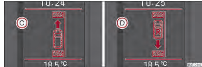
Abb. 124 Informationsdisplay: Hinweis für das Einlegen des Vorwärtsgangs (C) bzw. des Rückwärtsgangs (D)
