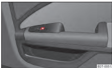
Abb. 28 Anordnung des Schalters in einer hinteren Tür
