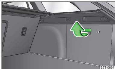
Abb. 107 Gepäckraum Superb Combi: Fach rechts öffnen
