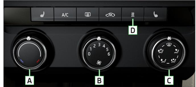
Einzelne Funktionen lassen sich durch Drücken der jeweiligen Taste einstellen bzw. einschalten. Bei eingeschalteter Funktion leuchtet unterhalb der Taste die Kontrollleuchte.
