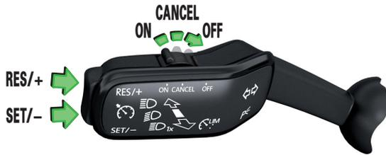
Die Geschwindigkeitsregelanlage regelt die eingestellte Geschwindigkeit, ohne dass das Gaspedal betätigt werden muss.
