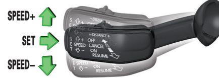
Die automatische Distanzregelung regelt die eingestellte Geschwindigkeit und den Abstand zu vorausfahrenden Fahrzeugen, ohne dass das Gas- oder Bremspedal betätigt werden muss.
