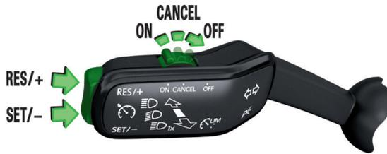
Die Geschwindigkeitsregelanlage regelt die eingestellte Geschwindigkeit, ohne dass das Gaspedal betätigt werden muss. Während der Regelung leuchtet im Kombi-Instrument die Kontrollleuchte
