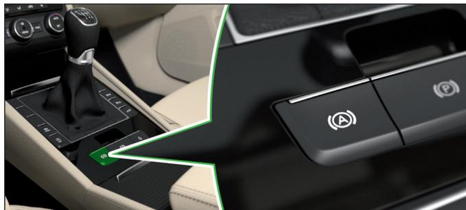
Die Auto Hold Funktion sichert das Fahrzeug beim Anhalten gegen Wegrollen. Die Sicherung des Fahrzeugs wird durch Aufleuchten der Kontrollleuchte
